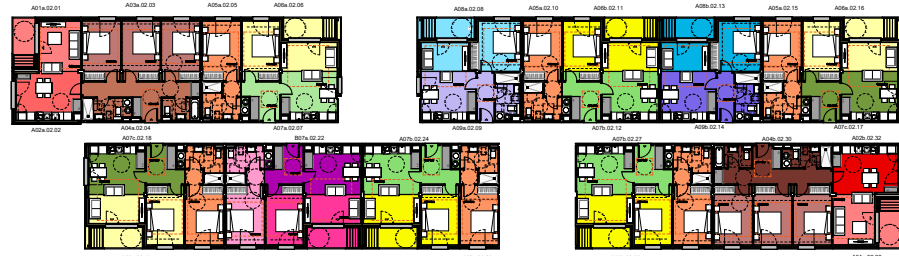
Montaje de las unidades de módulos industrializados (33 módulos)
